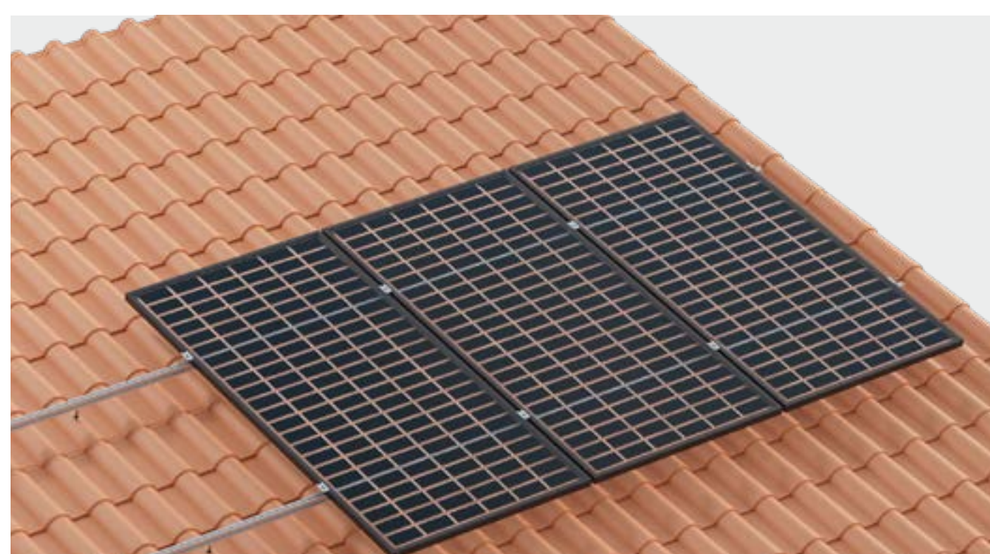
Disposizione verticale dei moduli.
