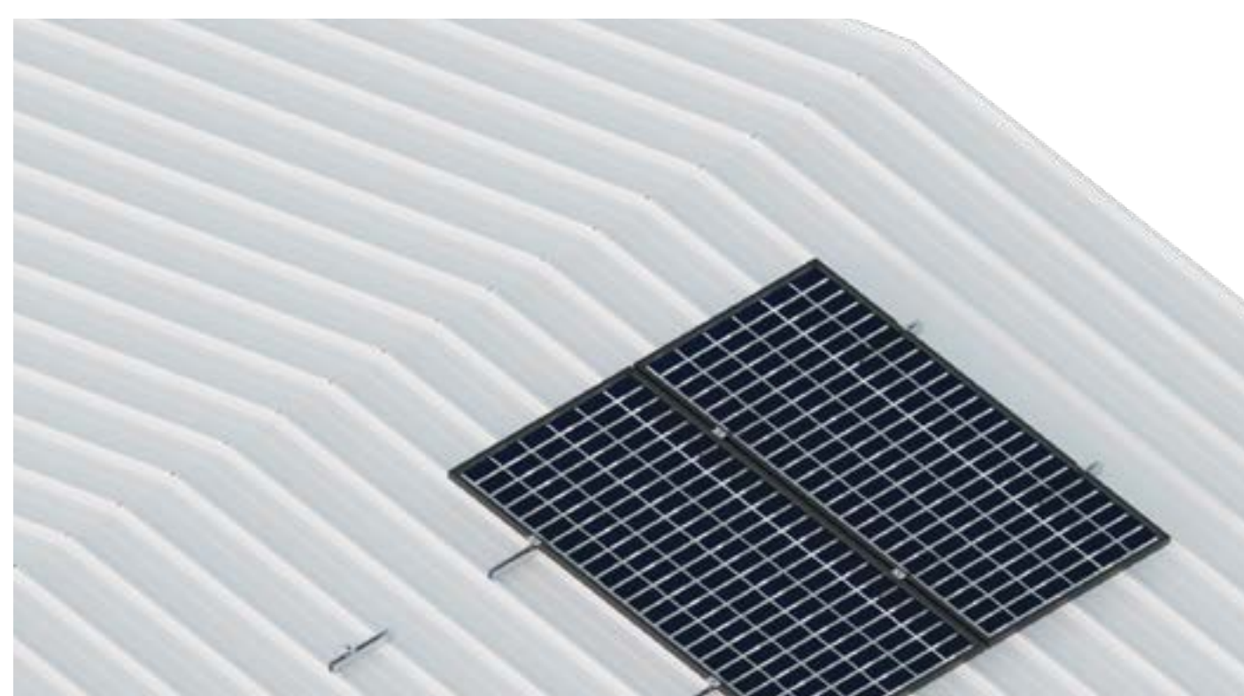
Disposizione verticale dei moduli.
