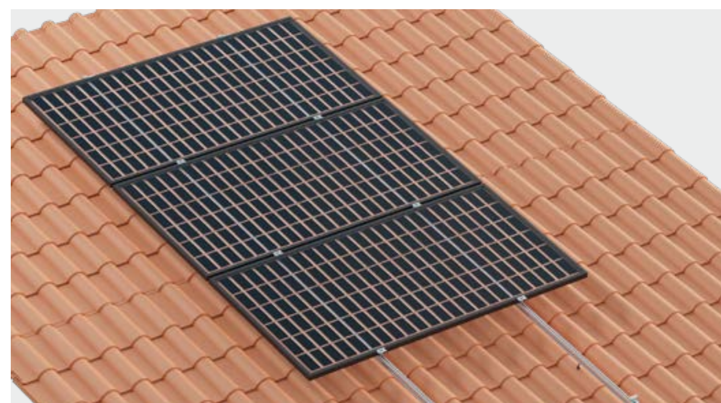
Disposizione orizzontale dei moduli.
